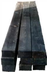
**枕木**：長さ 2.0m × 幅 20cm × 厚さ 10cm。国産スギに無害な防腐処理を施した特殊な木材を使用。一般の枕木はクレオゾールという強い防腐剤を使用しており生物に影響を与えます。土留め用、橋、デッキ、階段などに使用します。
