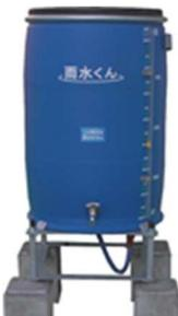
**雨水タンク**：貯水量は約 200 リットル。整管から雨水を取水しタンクへ溜めます。降雨がない場合は、補給水として水道から給水するフロート弁が備わっています。
